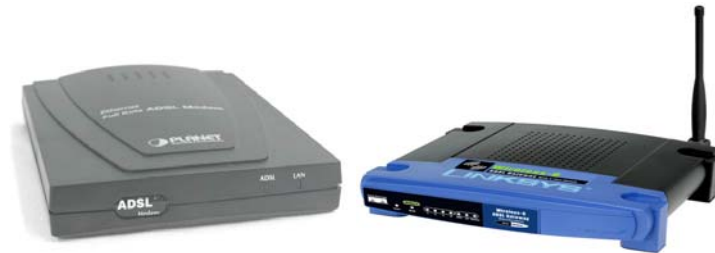
รูปที่ 1-25 ลักษณะของ ADSL Modem และ Wireless ADSL Modem
